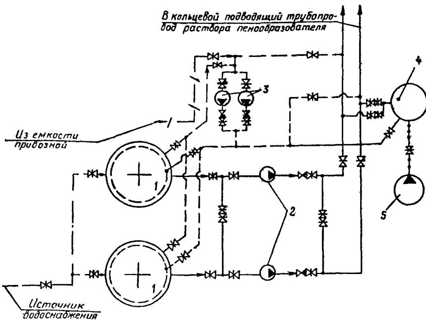
Для снятия характеристики пеногенераторов или пенных оросителей при различных режимах работы, в схеме установки пожаротушения рекомендуется на напорном трубопроводе между насосом и ближайшей от насоса задвижкой установить специальный огвод,
