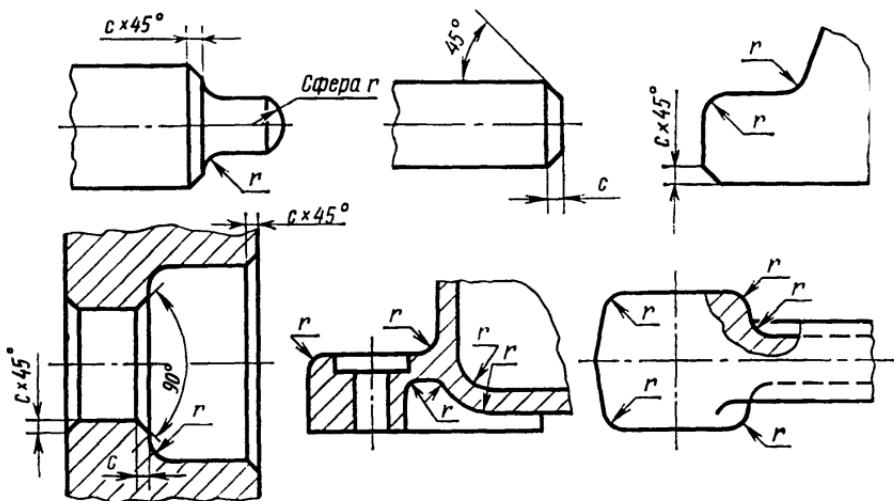
Примечание. В обоснованных случаях допускается применять фаски с углами, отличными от  $45^\circ$ .
