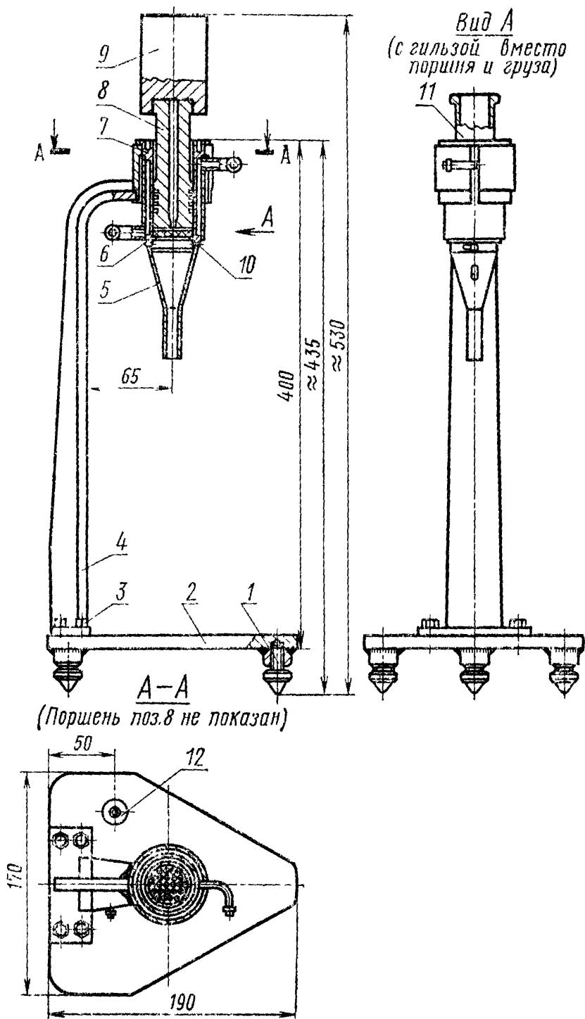
1—винт установочный; 2—плита; 3—болт; 4—кронштейн;
