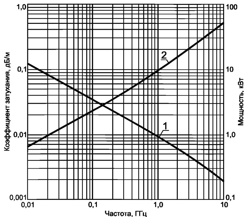
1 — допустимая мощность  $P$  на входе при температуре 40 °C и коэффициент стоячей волны напряжения, равном 1;
