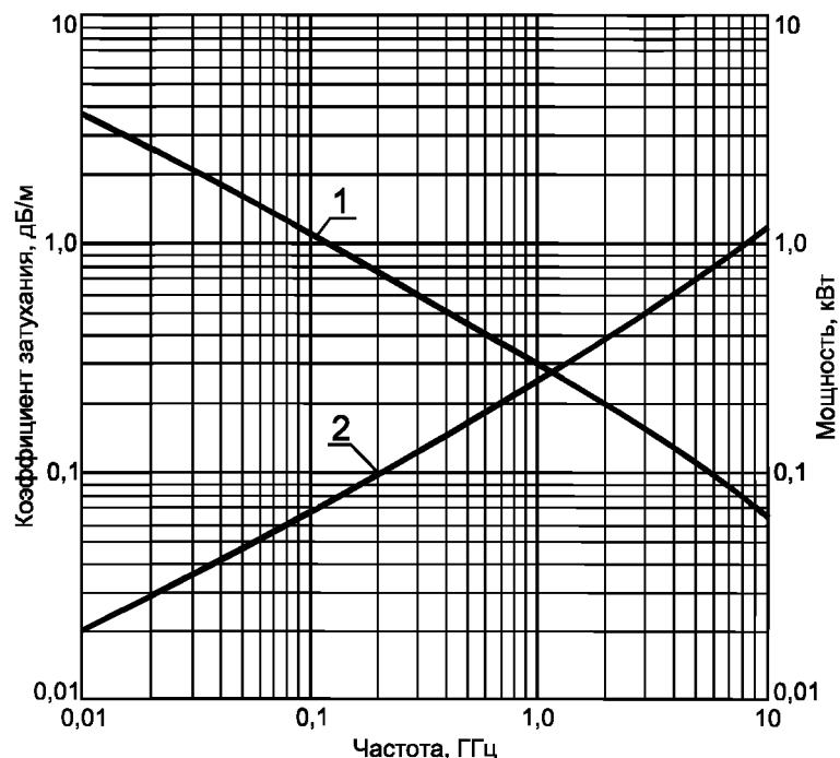
1 — допустимая мощность  $P$  на входе при температуре  $40^{\circ}\text{C}$  и коэффициенте стоячей волны напряжения, равном 1;
