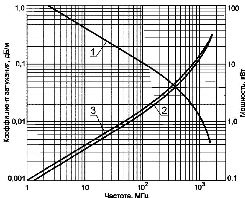
1 — допустимая мощность Р на входе при температуре 40 °С и коэффициенте стоячей волны напряжения, равном 1;
