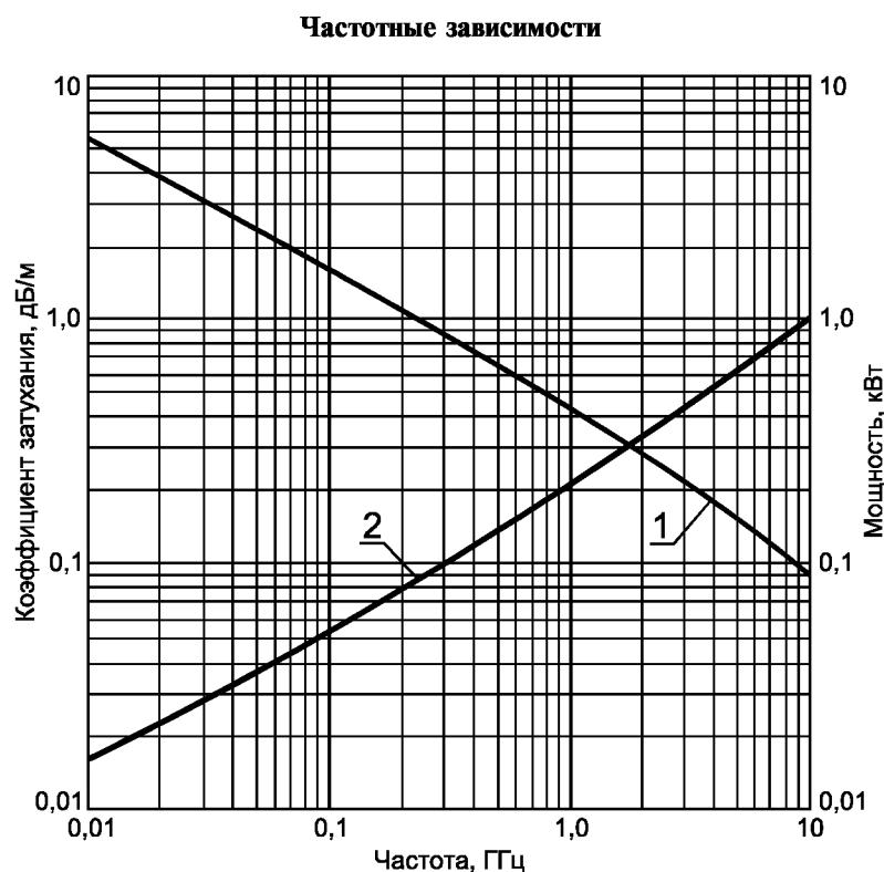
1 — допустимая мощность  $P$  на входе при температуре 40 °С и коэффициенте стоячей волны напряжения, равном 1;
