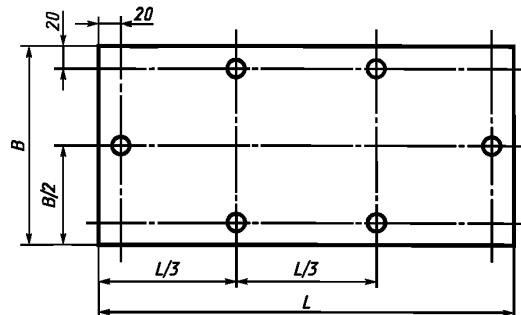
4.4. Толщину фанеры измеряют с погрешностью не более 0,1 мм толщиномером по ГОСТ 11358—89 на расстоянии не менее 20 мм от кромок листа в шести точках, указанных на чертеже.
