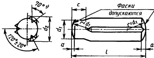
1) Угол насечки  $70^\circ$  применяется только на штифтах, изготовленных из стали, указанной в табл. 2. Угол насечки может изменяться в зависимости от пластичности материала.
