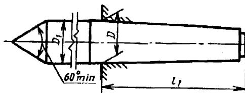
Центры токарных станков с конусом Морзе № 0—6 или метрическим
