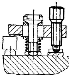
**Изменение № 2 ГОСТ 13434—68 Винты нажимные с шестигранный головкой и цилиндрическим концом для станочных приспособлений. Конструкция и размеры**
