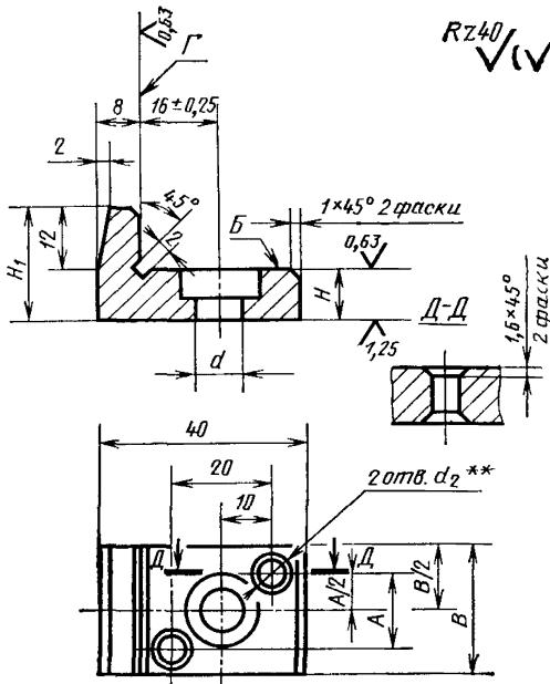
\*\* Отверстия под штифты развернуть при сборке с предельными отклонениями по К7.
