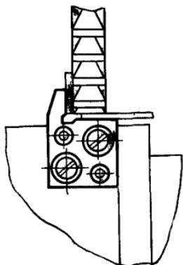
Изменение № 2 ГОСТ 13446—68 Установы угловые торцовые для стационарных приспособлений. Конструкция и размеры
