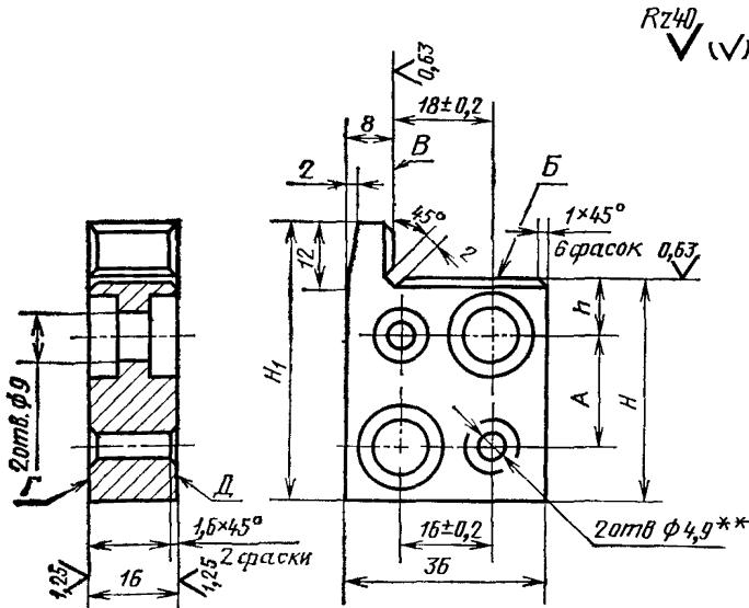
\*\* Отверстия под штифты развернуть при сборке с предельными отклонениями по К7.
