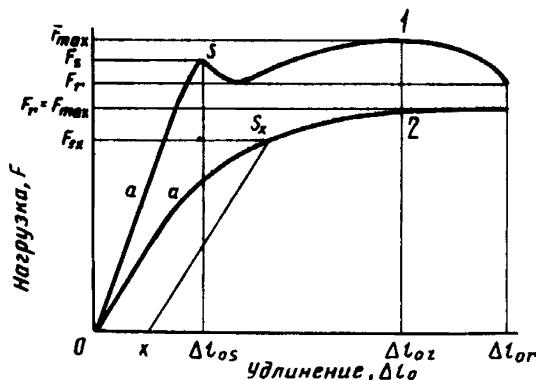
1—материал имеет предел текучести; 2—материал не имеет предела текучести; а—участки прямолинейного направления кривой в начале кривой «нагрузка—удлинение»;  $S_{\max}$ —предел текучести;  $x$ —отрезок на оси удлинения для определения условного предела текучести;  $S_x$ —условный предел текучести.
