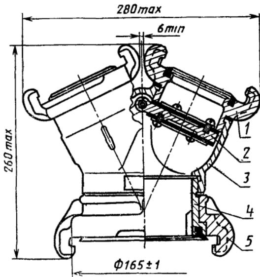
1; 5—соединительные головки; 2—клапан; 3—корпус; 4—выходной патрубок
