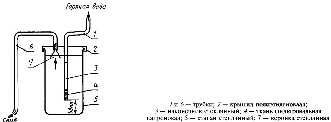
1 и 6 — трубы; 2 — крышка полиэтиленовая;
