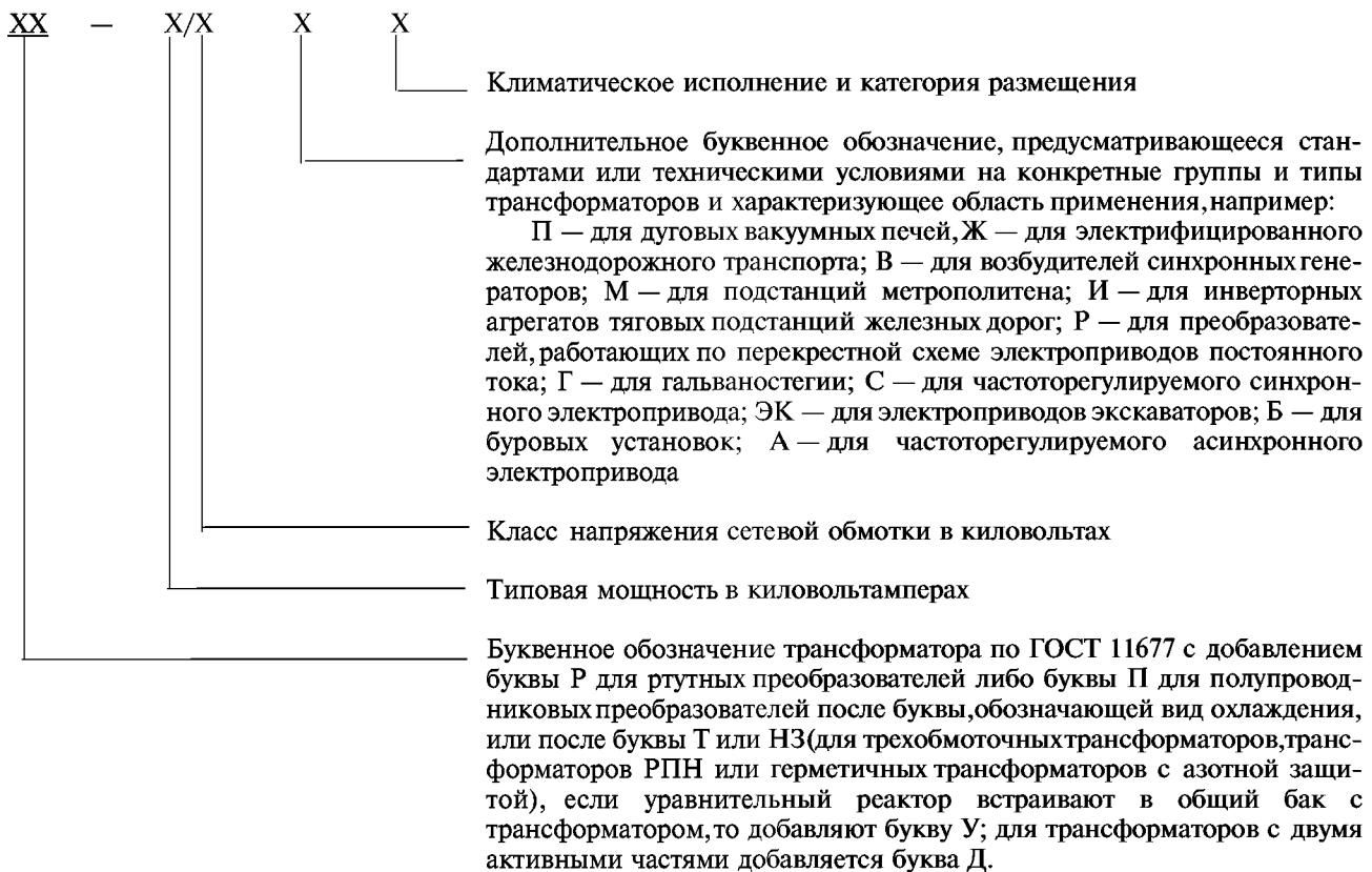
Пример условного обозначения трехфазного трансформатора с естественным масляным охлаждением, с регулированием напряжения под нагрузкой, для полупроводниковых преобразователей, типовой мощностью 4000 кВ·А, класса напряжения 35 кВ, климатического исполнения У, категории 2:
