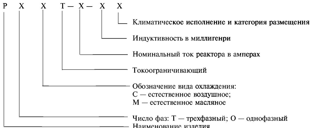
Пример условного обозначения трехфазного токоограничивающего реактора с естественным воздушным охлаждением на ток 820 А, индуктивность 0,5 мГ, климатического исполнения У, категории 4:
