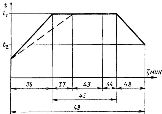
$t_1$ —температура стерилизации, °С;  $t_2$ —температура охлаждения, °С; —— изменение температуры в точках полезного объема наиболее труднодоступных для стерилизующего агента
