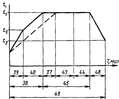
$t_1$  — температура стерилизации, °C;  $t_2$  — точка кипения воды при атмосферном давлении, °C;  $t_3$  — температура охлаждения, °C; — изменение температуры в точках полезного объема наиболее труднодоступных для стерилизующего агента
