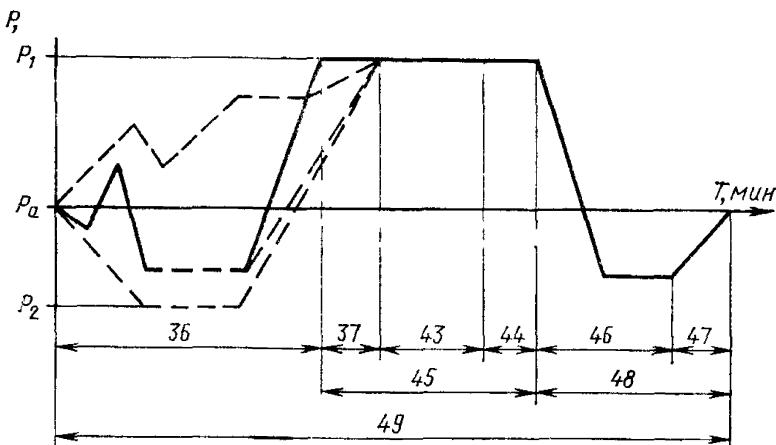
$P_a$  — атмосферное давление, Па;  $P_i$  — давление пара при температуре стерилизации, Па;  $P_2$  — вакуум по заданной программе, Па; — изменение давления в точках полезного объема наиболее труднодоступных для стерилизующего агента
