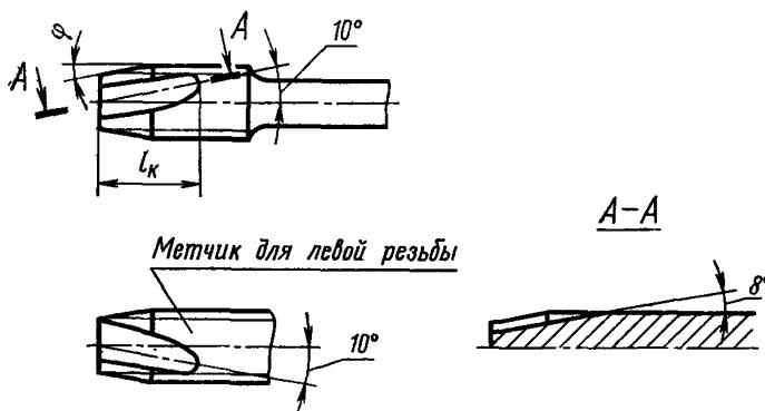
**П р и м е ч а н и е.** Режущая часть метчика затылковывается до остра под углом  $\alpha=6^\circ\pm2^\circ$ .
