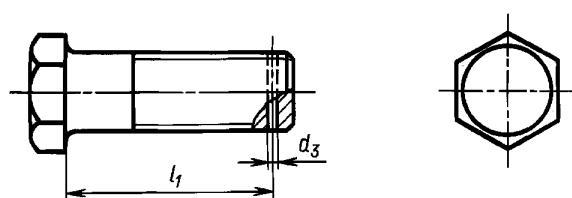
\* Шероховатость боковых сторон профиля резьбы и гладкой части стержня для болтов повышенной точности должна быть не более Rz 20 мкм.
