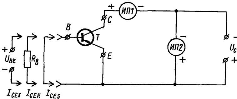
*ИП1*—измеритель постоянного тока; *ИП2*—измеритель постоянного напряжения,  $U_C$ —напряжение источника питания коллектора;  $R_B$ —резистор в цепи базы,  $T$ —испытуемый транзистор;  $U_{BE}$ —напряжение источника питания эмиттер-база.
