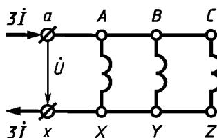
К. п. 115. Сопротивление сдвоенного реактора
