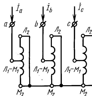
Зажимы фаз одинарного реактора;  $A, X, B, Y, C, Z$  или  $L_1, L_2$ ; зажимы фазы сдвоенного реактора:  $L_1 - M_1, L_2, M_2$ ; зажимы источника практически синусоидального напряжения номинальной частоты; однофазного —  $a, x$ ; трехфазного —  $a, b, c$
