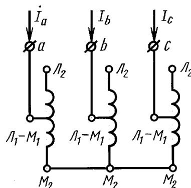
**К. п. 117. Сквозное сопротивление сдвоенного реактора**
