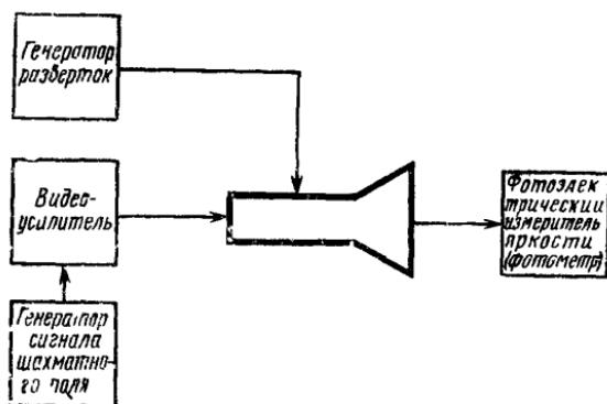
1.3. Генератор разверток должен обеспечивать разложение изображения по ГОСТ 7845—55. Нелинейность разверток — не более  $\pm 10\%$ .
