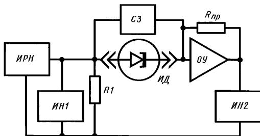
*ИРН* — источник регулируемого напряжения; *СЗ* — схема защиты; *ИД* — измеряемый диод; *R<sub>1</sub>* — резистор, обеспечивающий условие устойчивого смещения в рабочую точку; *R<sub>пр</sub>* — прецизионный резистор; *ИН1*, *ИН2* — измерители напряжения; *ОУ* — операционный усилитель
