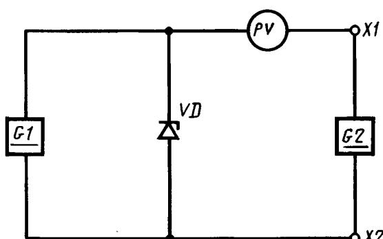
2.1. Напряжение стабилизации следует измерять на установке, структурная схема которой приведена на чертеже.
