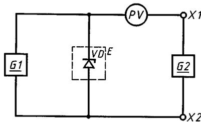
*G1* — генератор постоянного тока; *VD* — измеряемый стабилитрон; *E* — термостат; *PV* — измеритель постоянного тока; *G2* — источник опорного напряжения; *X1*, *X2* — выводы
