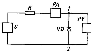
*G* — генератор постоянного или пульсирующего напряжения; *R* — резистор; *PA* — измеритель тока; *VD* — испытуемый диод; *PV* — измеритель напряжения
