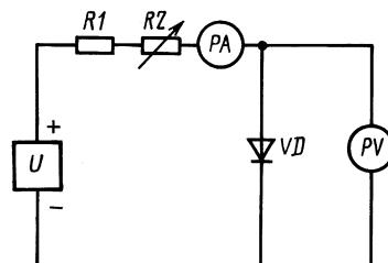
$U$  — источник напряжения;  $R1$  — ограничительный резистор;  $R2$  — переменный резистор;  $RA$  — измеритель постоянного тока;  $VD$  — измеряемый диод;  $PV$  — измеритель постоянного напряжения
