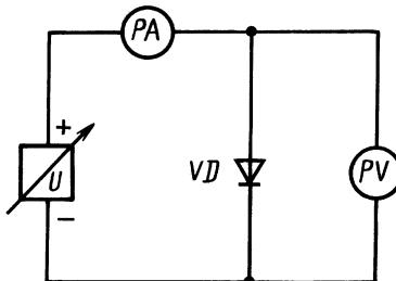
$U$  — регулируемый источник напряжения;  $PA$  — измеритель постоянного тока;  $VD$  — измеряемый диод;  $PV$  — измеритель постоянного прямого напряжения
