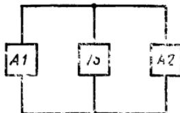
*A1*—устройство задания электрического режима в цепи основных выводов тиристора; *VS*—испытуемый тиристор; *A2*—измерительное устройство для измерения напряжения переключения
