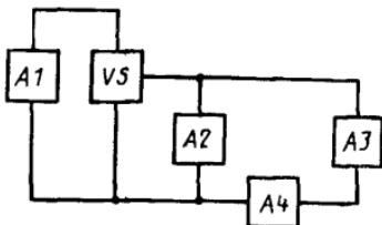
2.2. Устройство *A1* должно обеспечивать задание режима в цепи основных электродов тиристора в соответствии с п. 1.1.
