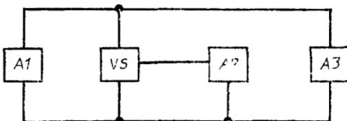
*A1*—устройство задания режима в цепи основных выводов тиристора; *VS*—испытуемый тиристор; *A2*—устройство задания режима в цепи управления (для диодных тиристоров отсутствует); *A3*—измерительное устройство для измерения критической скорости нарастания напряжения в закрытом состоянии
