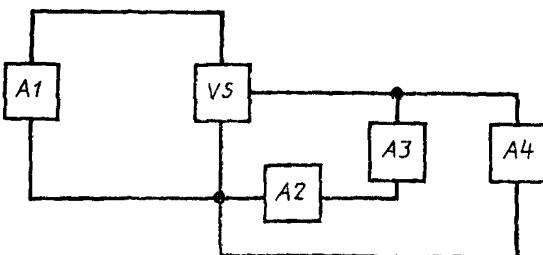
*A1*—устройство задания режима в цепи основных выводов тиристора; *VS*—испытуемый тиристор; *A2*—измерительное устройство для измерения неотпирающего (постоянного или импульсного) тока управления; *A3*—устройство задания режима в цепи управления; *A4*—измерительное устройство для измерения неотпирающего постоянного или импульсного напряжения управления
