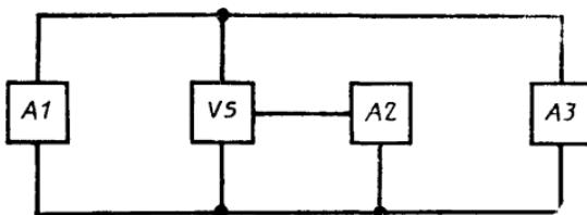
*A1—устройство задания режима в цепи основных выводов тиристора; VS—испытуемый тиристор; A2—устройство задания режима в цепи управления (для диодных тиристоров отсутствует); A3—измерительное устройство для измерения напряжения в открытом состоянии*
