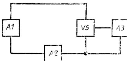
*A1—устройство задания электрического режима в цепи основных выводов тиристора; A2—измерительное устройство для измерения тока в закрытом состоянии и (или) обратного тока; VS—испытуемый тиристор; A3—устройство задания режима в цепи управления (для диодных тиристоров отсутствует)*
