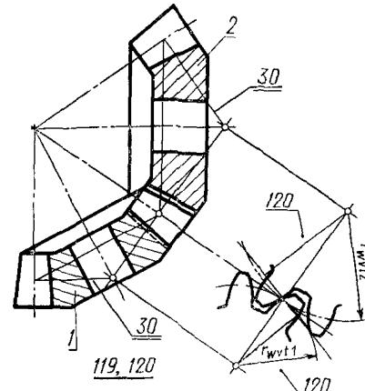
ской передачи равны длинам образующих начальных дополнительных конусов шестерни и колеса конической зубчатой передачи, соответствующих заданному начальному конусному расстоянию.
