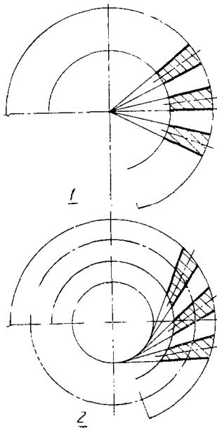
**3 Коническое зубчатое колесо с криволинейными зубьями**
