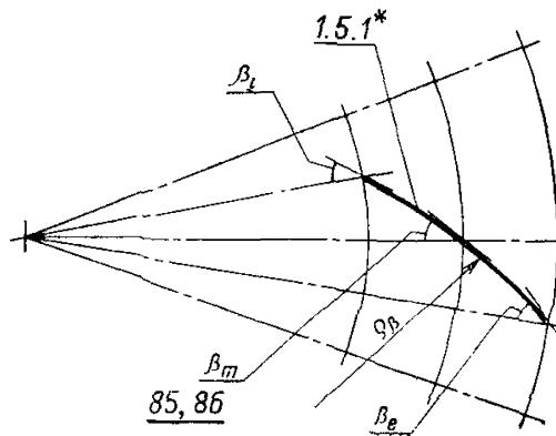
**86. Радиус кривизны делительной линии зуба плоского колеса**
