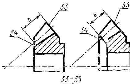
$K_{be}(K_{bm})$  Отношение ширины зубчатого венца конического зубчатого колеса к его внешнему (среднему) делительному конусному расстоянию
