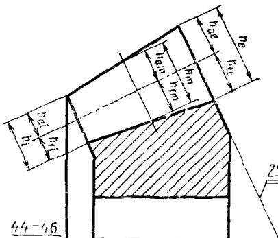
**45. Высота делительной головки зуба конического зубчатого колеса**
