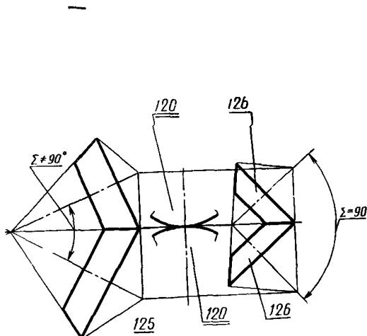
127. Число зубьев эквивалентного конического зубчатого колеса
