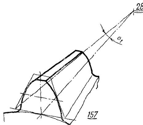
158. Угол сходимости линий дна впадины конического зубчатого колеса с прямыми (тangenциальными) зубьями
