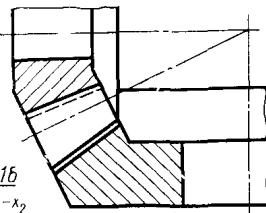
**116. Равносмещенная коническая передача**
