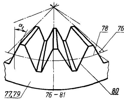
ленной от его оси, второй — со стороны, наименее удаленной, третий находится на равном расстоянии от внешнего и внутреннего дополнительных цилиндров, а др. — на заданном расстоянии от оси плоского колеса
