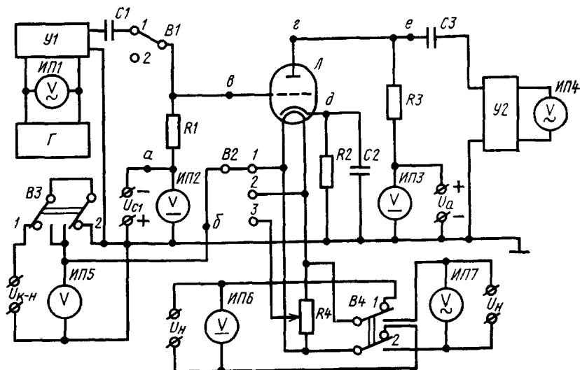
$\Gamma$  — генератор,  $ИП1, ИП4, ИП7$  — вольтметры переменного тока;  $ИП2, ИП3$ ,  $ИП6$  — вольтметры постоянного тока;  $ИП5$  — вольтметр;  $У1$  — делитель напряжения;  $У2$  — фильтр;  $C1, C2, C3$  — конденсаторы;  $R1 — R4$  — резисторы;  $B1 — B4$  — переключатели;  $a, б, в, г, д$  — вспомогательные обозначения точек схемы;  $L$  — испытываемая лампа.
