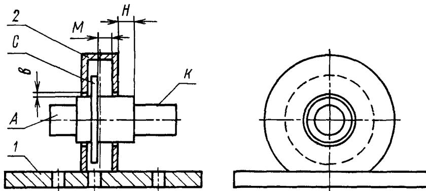
1—лицевая плата измерительной панели с отверстиями для контактов, обеспечивающих подключение лампы к измерительной установке; 2—экран с отверстиями;  $A$ ,  $C$ ,  $K$ —контактные поверхности выводов электродов испытываемой лампы.
