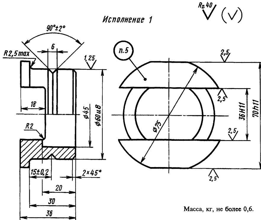
Условное обозначение направляющей втулки исполнения 1:
