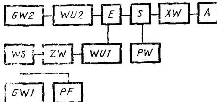
*GW1*—генератор СВЧ мощности; *PF*—частотомер;
