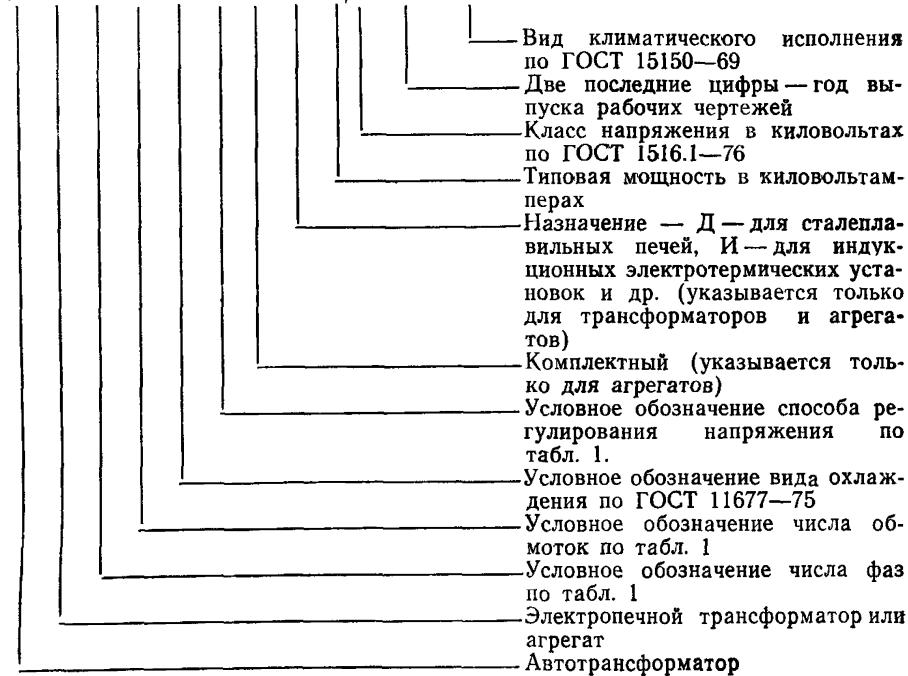
1.4. Структура условного обозначения сухих трансформаторов должна указываться в стандартах или технических условиях на конкретные типы трансформаторов.
