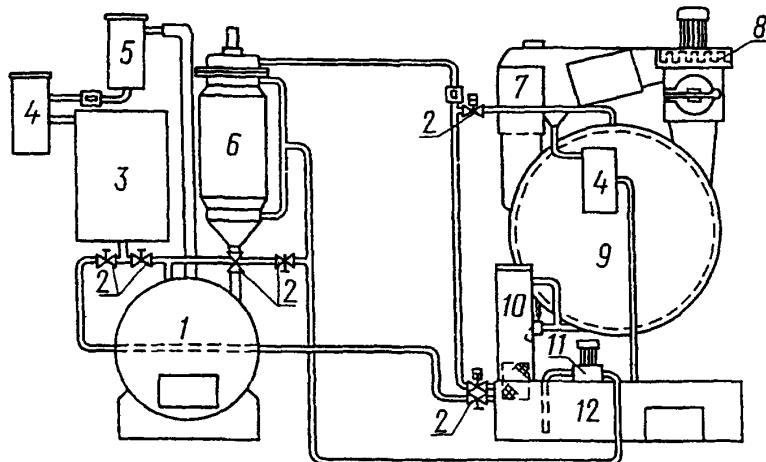
1 — дистилляционная установка; 2 — вентили; 3 — сборный бак чистого растворителя; 4 — водоотделитель;
