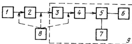
1—лазер, 2—ослабитель; 3—оптическая система, 4—апертурная диафрагма, 5—измерительный преобразователь, 6—измерительный прибор 7—устройство сканирования, 8—средство юстировки, 9—средство измерения ОРПЭ(М)
