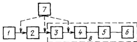
1—лазер; 2—ослабитель; 3—оптическая система, 4—матричный преобразователь; 5—коммутирующее устройство; 6—измерительный прибор; 7—средство юстировки; 8—средство измерения ОРПЭ(М)
