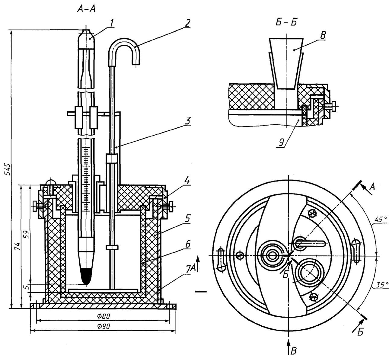
1 — термометр с муфтами; 2 — ручка мешалки; 3 — ручка крышки; 4 — крышка; 5 — термоизоляционный стакан;
