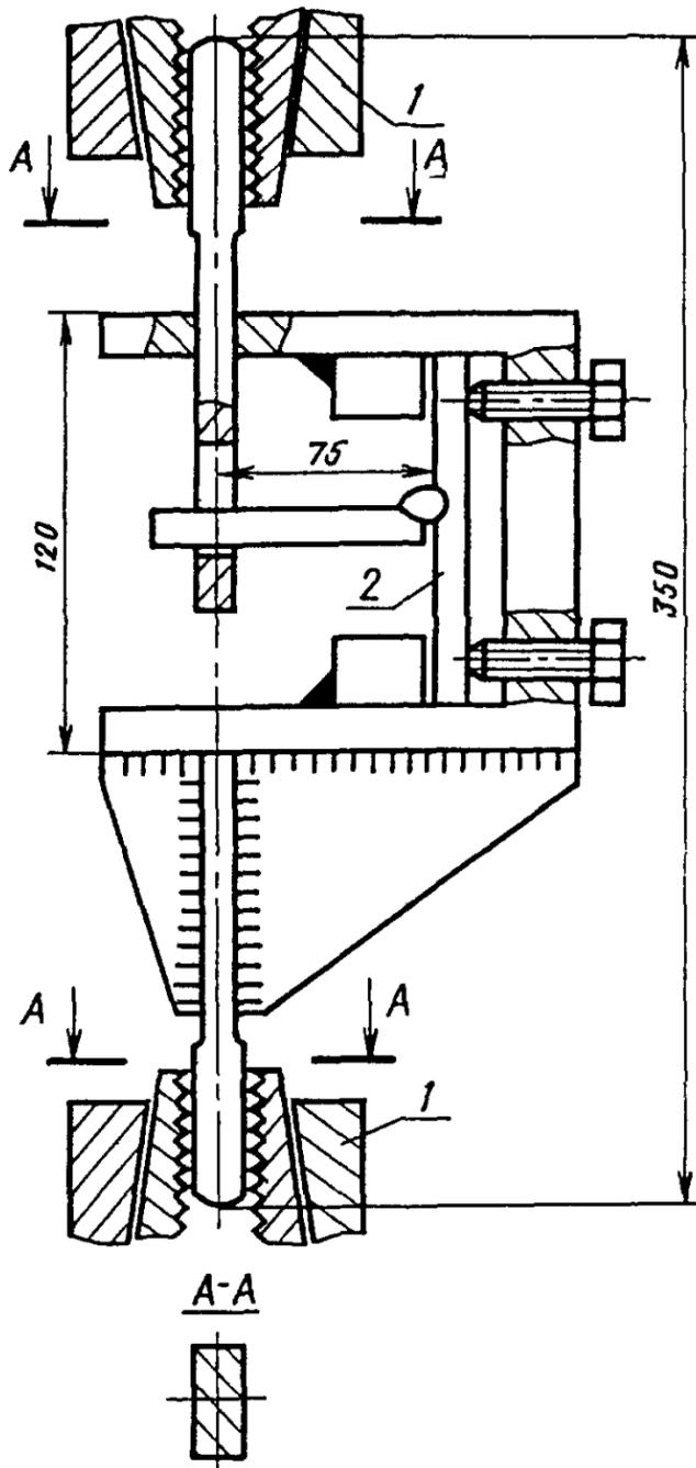
1—захват машины; 2—образец
