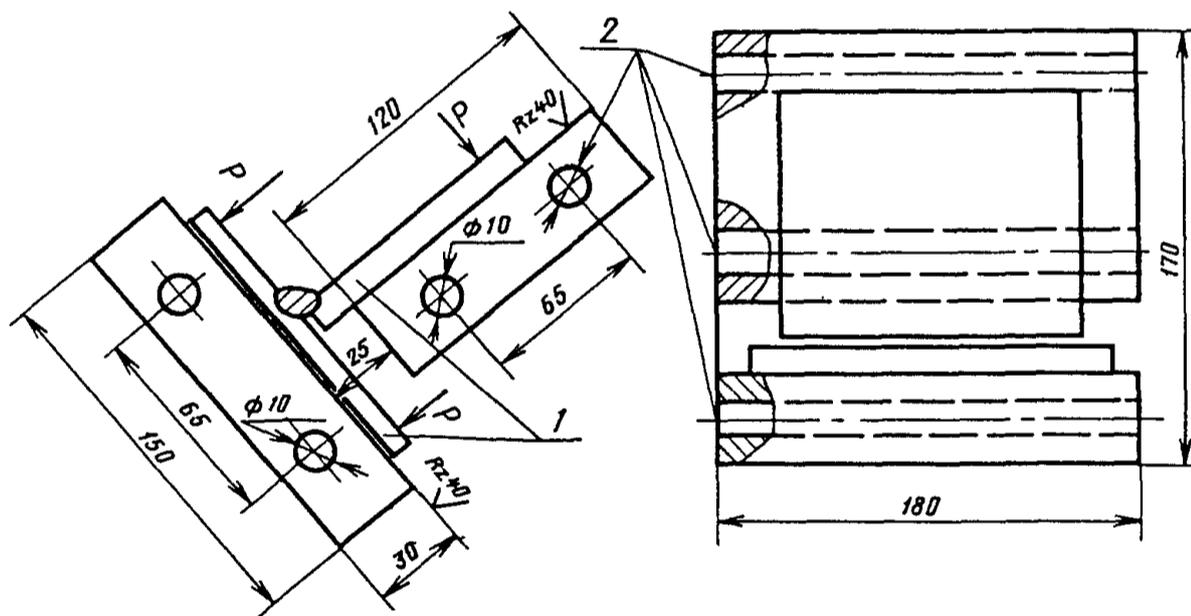
1—образец типа II, 2—отверстия для подачи воды
