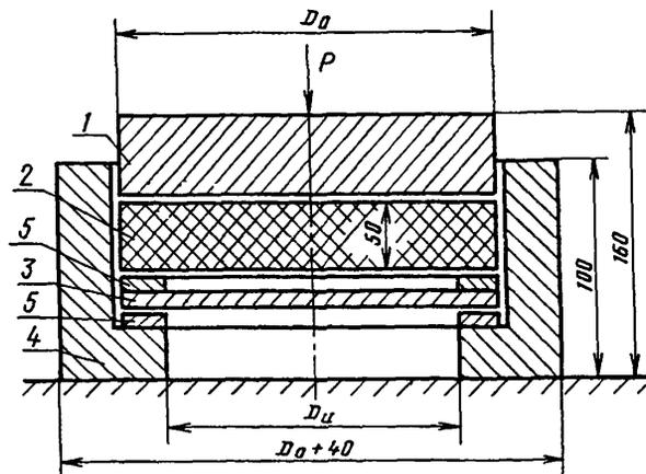
1—пуансон; 2—резина, гидропластмасса или другие эластичные рабочие тела; 3—образец; 4—опорный фланец; 5—подкладные нарезные кольца
