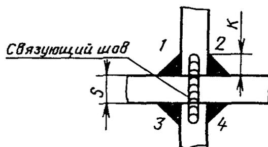
1, 2, 3, 4—последовательность выполнения швов на образце;  $l_w$ —длина сварного шва,  $B_r$ —ширина горизонтальной полки образца;  $l_n$ —длина сварного шва, вырезаемого для исследования
