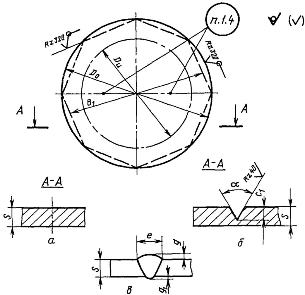
а—стыковое соединение без разделки кромок, б—стыковое соединение с разделкой кромок; в—общий вид сварного соединения, s—толщина образца; D<sub>0</sub>—диаметр образца; B<sub>1</sub>—размер между гранями восьмигранного образца; α—угол разделки образца; C<sub>1</sub>—глубина разделки; D<sub>и</sub>—диаметр рабочей части образца
