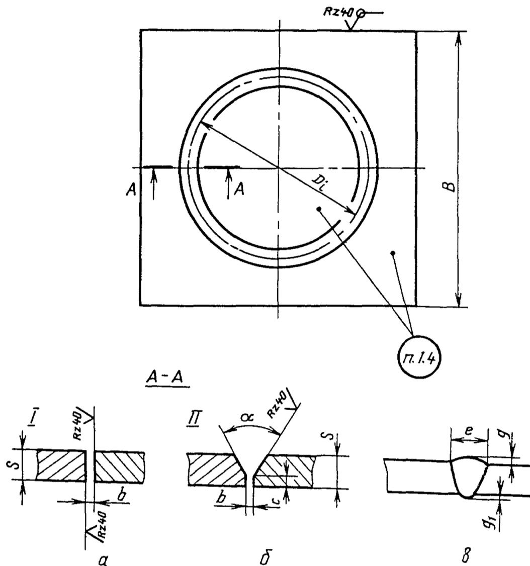
*a*—образец без разделки кромок; *b*—образец с разделкой кромок; *в*—общий вид сварного соединения;  $D_1$ —переменный диаметр рабочей части образца; *c*—притупление разделки кромок; *g*—усиление сварного шва снаружи;  $g_1$ —усиление сварного шва в корне
