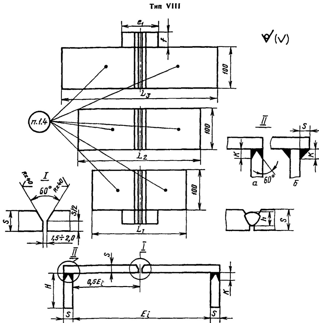
$E_i$  — переменное расстояние между пластинами-концевиками;  $L_i$  — переменная длина образца
