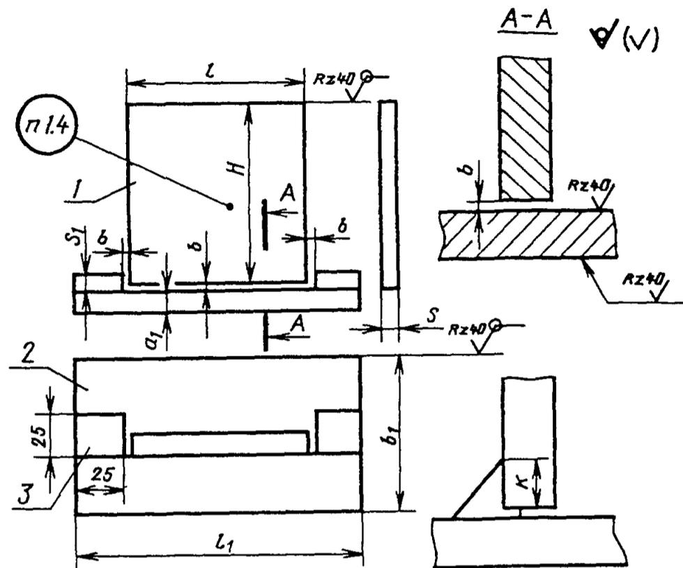
1—длина вертикальной стенки образца,  $s$ —толщина входной и выходной планки,  $H$ —высота стенки образца,  $b_1$ —ширина основания образца,  $l_1$ —длина полки образца,  $b$ —величина зазора,  $K$ —катет сварного шва, 1—стенка из испытываемой стали, 2—полка из низкоуглеродистой стали, 3—входные и выходные планки из низкоуглеродистой стали
