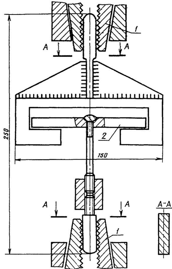
1—захват машины, 2—образец
