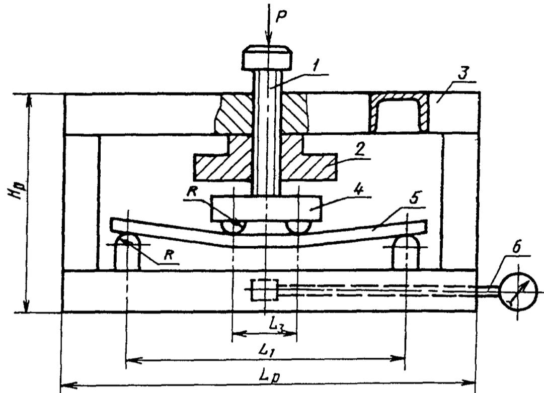
$L_1$ —расстояние между опорами основания.  $L_2$ —расстояние между опорами на пуансоне;  $P$ —нагрузка при испытании;  $H_p$ —высота рамы;  $L_p$ —длина рамы.  $R$ —радиус скругления опоры; 1—шток; 2—гайка, фиксирующая прогиб образца. 3—рама (из швеллера № 10); 4—пуансон; 5—образец, 6—измеритель прогиба
