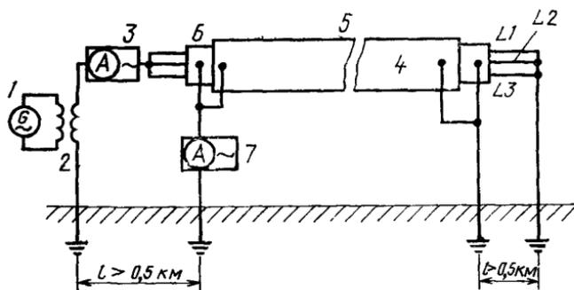
1 — генератор; 2 — согласующий трансформатор; 3 — устройство для измерения величины тока в жилах кабеля; 4 — силовоточный кабель; 5 — броня; 6 — оболочка; 7 — устройство для измерения величины тока в оболочке и в броне;  $L_1, L_2, L_3$  — жила силовоточного кабеля;  $l$  — расстояние между устройствами заземления
