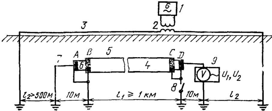
1 — генератор; 2 — согласующий трансформатор; 3 — цепь питания; 4 — кабель связи; 5 — броня; 6 — оболочка; 7 — жила; 8 — выключатель; 9 — селективный вольтметр;  $l_1$  — длина измерительного участка;  $l_2$  — участки между концами измерительного участка и концами искусственной влияющей цепи; A, B, C, D — кольцевые электроды, которые припаяны к оболочке и броне
