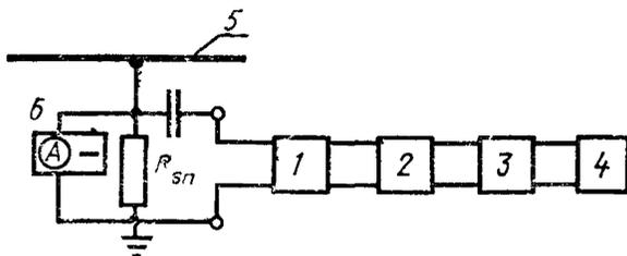
1 — устройство согласования для коэффициента  $h_f$ , состоящее из одного резистивно емкостного звена, 2 — усилитель, 3 — псофометр, 4 — самопишущий измерительный прибор, 5 — контактный провод, 6 — вольтметр постоянного тока, градуированный в амперах
