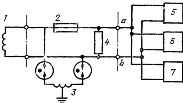
1 — преобразователь тока, 2 — предохранитель; 3 — двухэлектродный разрядник с дренажной катушкой; 4 — измерительный резистор; 5 — селективный вольтметр (анализатор гармоник); 6 — вольтметр для измерения эффективных значений; 7 — псофометр
