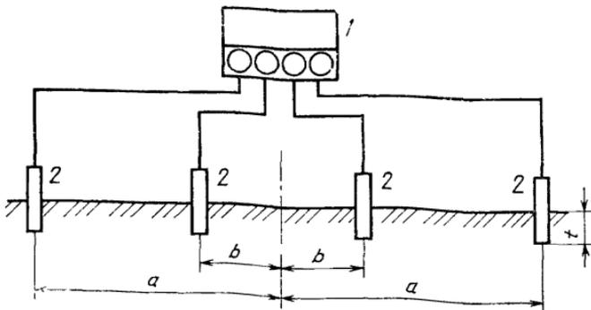
1 — измеритель сопротивления заземления (измерительные электроды);  $0,1 \text{ м} \leq t \leq 0,15 \text{ м}$ ;  $1,5 \text{ м} \leq a \leq 20 \text{ м}$ ;
