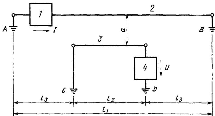
1 — генератор тока; 2 — развернутая линия питания длиной  $l_1$ ; 3 — развернутая измерительная цепь длиной  $l_2$ ; 4 — селективный вольтметр; A, B — конечные точки цепи питания; C, D — конечные точки измерительной цепи;  $a$  — расстояние между цепью питания и измерительной линией;  $l_3$  — расстояние между A и C или соответственно между D и B;  $2000 \text{ м} \leq l_1 \leq 3000 \text{ м}$ ;  $20 \text{ м} \leq l_2 \leq 60 \text{ м}$ ;  $50 \text{ м} \leq a \leq 300 \text{ м}$
