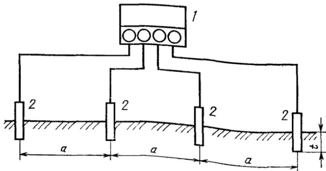
1 — измеритель сопротивления заземления, (измерительные электроды);  $0,1 \text{ м} \leq t \leq 0,15 \text{ м}$ ; 2 — стержни заземления;  $1,5 \text{ м} \leq a \leq 16 \text{ м}$
