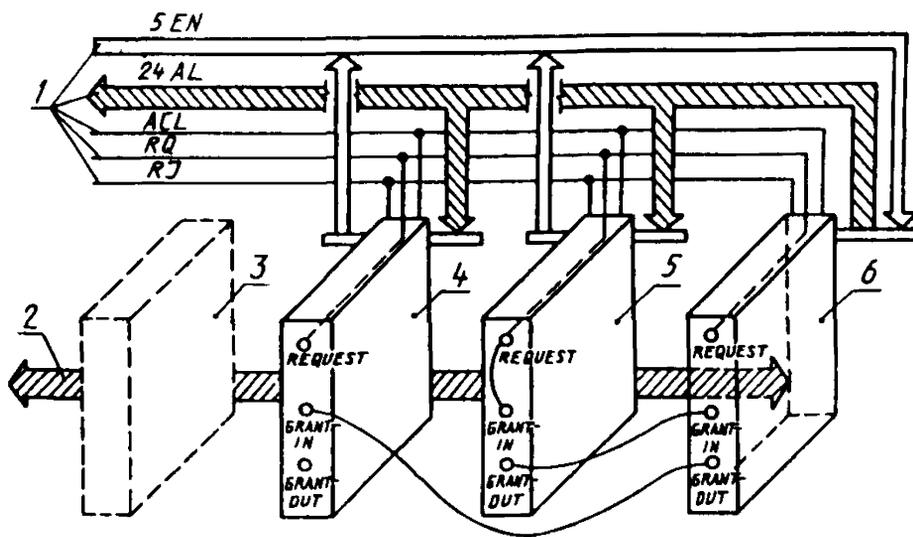
1 — линии магистрали дополнительного контроллера, 2 — магистраль крейта, 3 — модуль, 4 — дополнительный контроллер с наиминимум приоритетом, 5 — дополнительный контроллер с наивысшим приоритетом, 6 — крейт-контроллер
