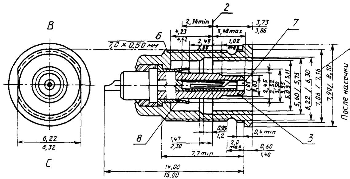
*A* — позиция *A*; *B* — позиция *B*; *C* — розетка, аналогичная поз. *B*, за исключением кабельного комплекта (как в поз. *A*); 1 — замыкающий механизм и заземляющий корпус; 2 — исходный уровень; 3 — изоляция; 4 — центровой контактный штепсель; 5 — типовое гофрированное снижающее сопротивление (допускается и негофрированное); 6 — резьба; 7 — центровые контактные розетки; 8 — наружный контакт пружинного типа (расширяющийся и шлицованный)
