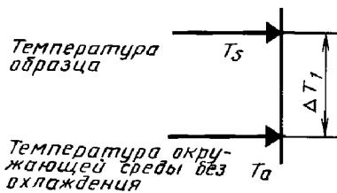
**Стадия 1.** Образец находится под нагрузкой. Испытание в условиях камеры без принудительной циркуляции воздуха и при отсутствии охлаждения образца.
