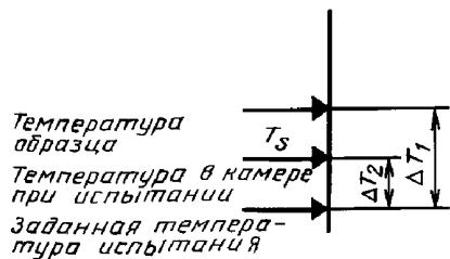
**Стадия 2.** Образец находится под нагрузкой. Испытание в камере при наличии принудительной циркуляции воздуха. Контроль при температуре образца ( $ΔT_2$  должно быть мало). Измерение температуры испытательной камеры проводят, как указано в п. 4 МЭК 68-1, п. 4 (ГОСТ 28198).
