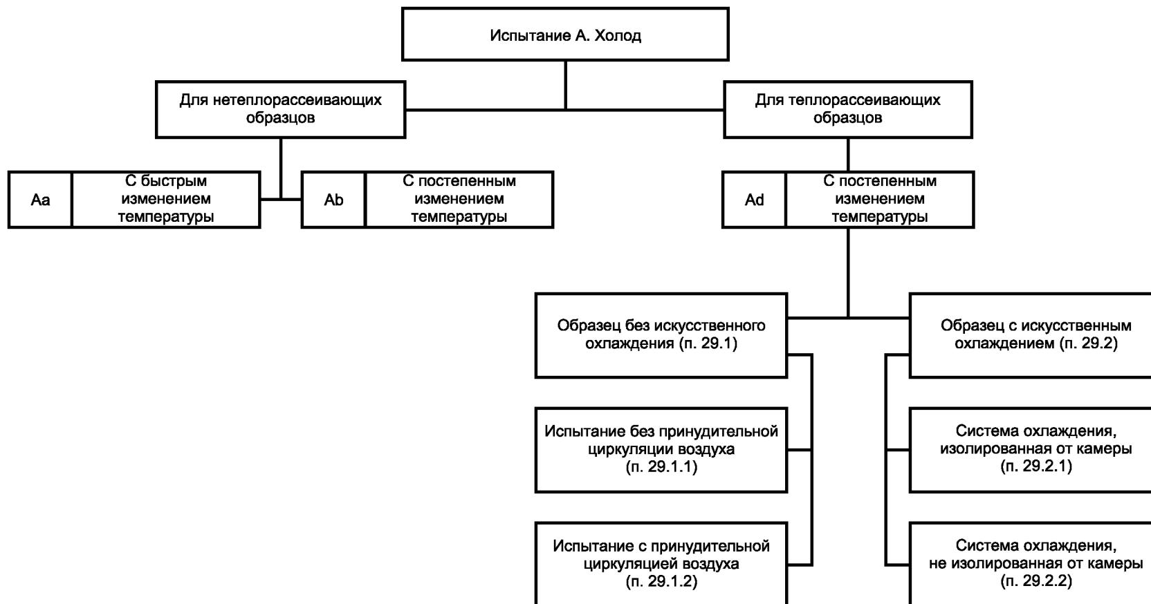
**Блок-схема испытания А: Холод, показывающая идентичность
