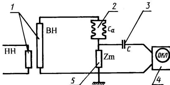
1 — трансформатор (ВН — высокое напряжение, НН — низкое напряжение); 2 — опорный изолятор ( $C_a$  — емкость активная); 3 — конденсатор; 4 — катодно-лучевой осциллограф (ОКЛ); 5 — высокочастотный фильтр
