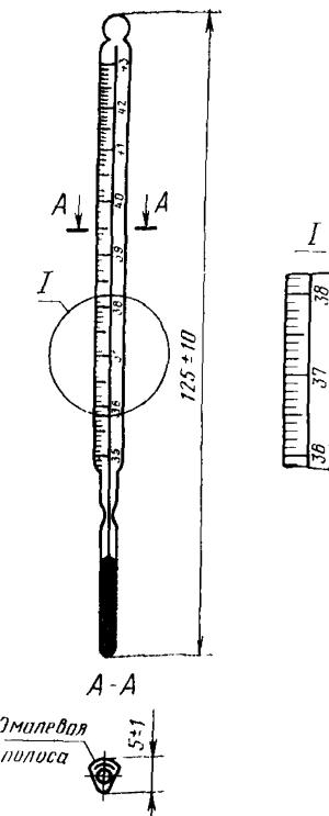
2.2. Термометр должен иметь специальное устройство, препятствующее спаданию ртутного столбика при охлаждении.
