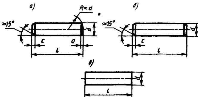
*a* - исполнение 1 (класс точности А); *b* - исполнение 2 (класс точности В); *c* - исполнение 3 (класс точности С)
