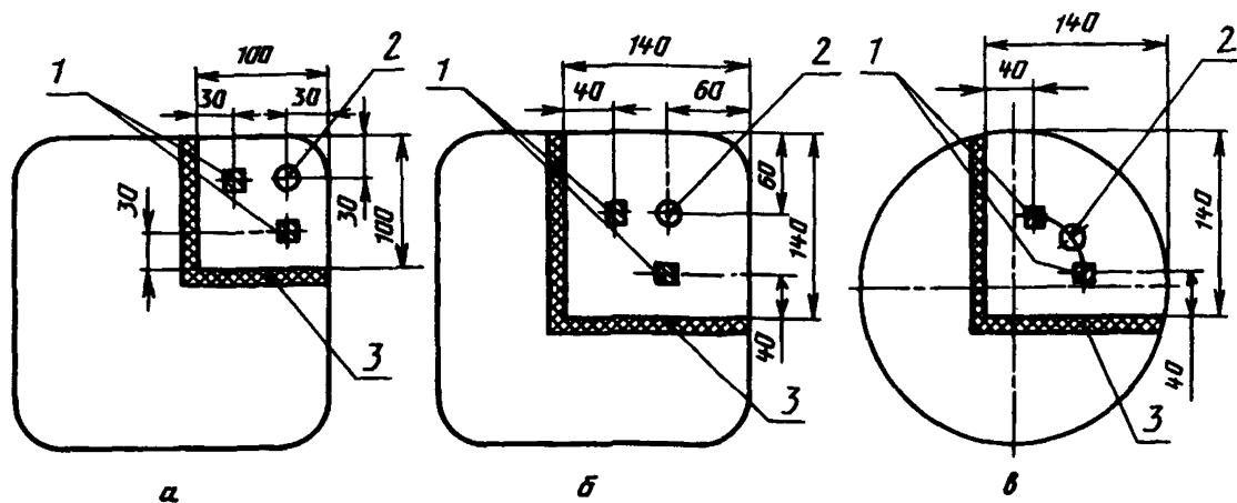
*a* — квадратная заготовка со стороной квадрата до 230 мм включительно; *б* — квадратная заготовка со стороной квадрата выше 230 мм; *в* — круглая заготовка; 1 — два бруска для четырех образцов для испытания на ударную вязкость; 2 — образец для испытания на растяжение; 3 — автогенный рез
