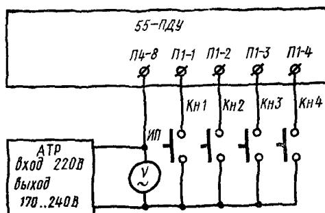
ИП—вольтметр, класс точности 1,0, Кн1—Кн4—кнопки с замыкающими контактами на ток не менее 0,5 А; АТР—автотрансформатор мощностью не менее 50 Вт.
