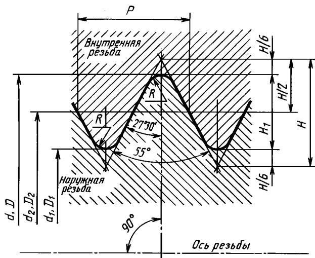
$d$  — наружный диаметр наружной резьбы (трубы);  $d_1$  — внутренний диаметр наружной резьбы;  $d_2$  — средний диаметр наружной резьбы;  $D$  — наружный диаметр внутренней резьбы (муфты);  $D_1$  — внутренний диаметр внутренней резьбы;  $D_2$  — средний диаметр внутренней резьбы;  $P$  — шаг резьбы;  $H$  — высота исходного треугольника;  $H_1$  — рабочая высота профиля;  $R$  — радиус закругления вершины и впадины резьбы
