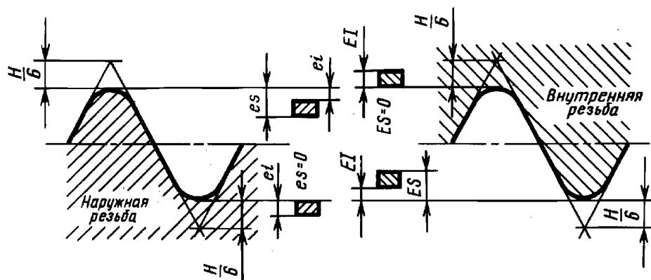
$es$  — верхнее отклонение среза вершины и впадины наружной резьбы;  $ES$  — верхнее отклонение среза вершины и впадины внутренней резьбы;  $ei$  — нижнее отклонение среза вершины и впадины наружной резьбы;  $EI$  — нижнее отклонение среза вершины и впадины внутренней резьбы
